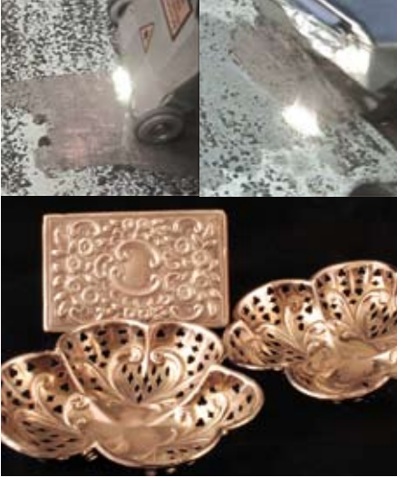
Schonende und kontrollierbare Laserreinigung von Metallen, z.B. Bronze oder Silber
