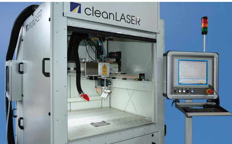
Großzügiger Arbeitsraum mit H-Portal
